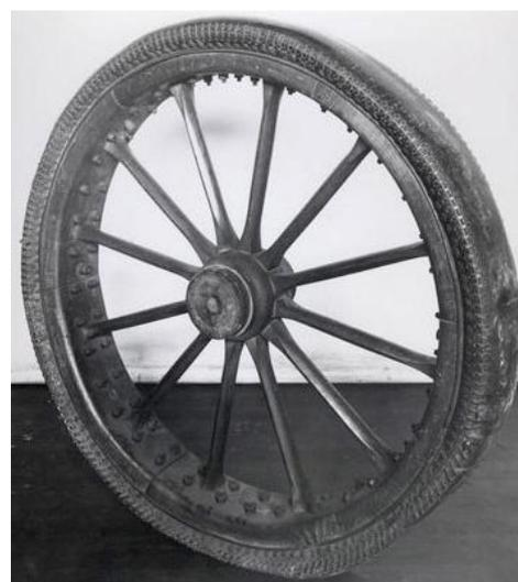
Рис. 6. Первая пневматическая шина, (1846 г.)
