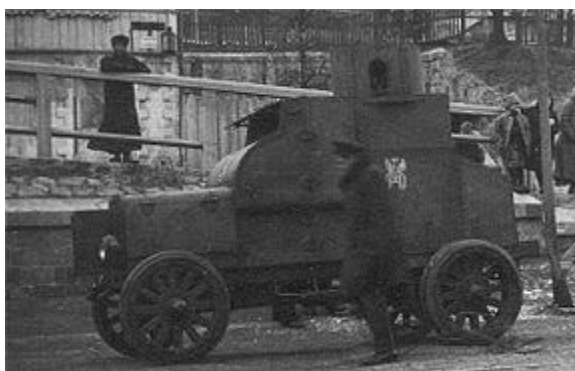
Броневый автомобиль «Фиат-Омский» на шинах типа «гусматик» (1917-1923 гг.)
