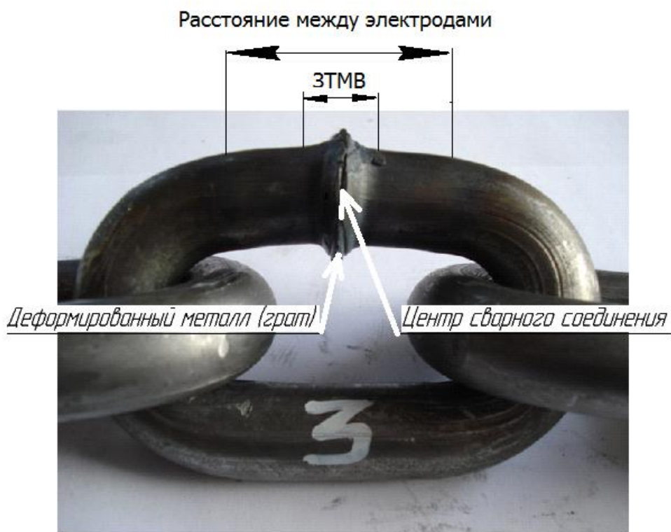
Рис. 6. Сваренное звено цепи 20x80 без обрезки грата
