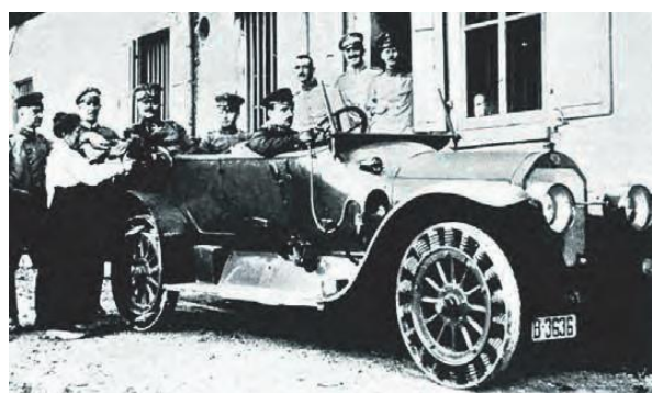
Рис. 5. Автомобиль с металлоупругими колёсами (1916 г.)
