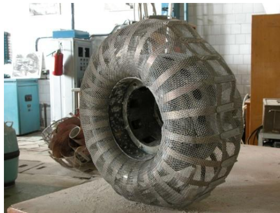
Рис. 9. Колесо для лунохода из упругой сетки (1970 г.)
