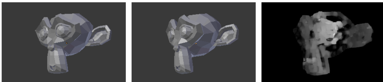
Рис. 3. 1 – первый кадр. 2 – второй кадр. 3 – карта глубин, полученная с помощью оптического потока Фарнебака, более светлым цветом выделены области, расположенные ближе к наблюдателю
