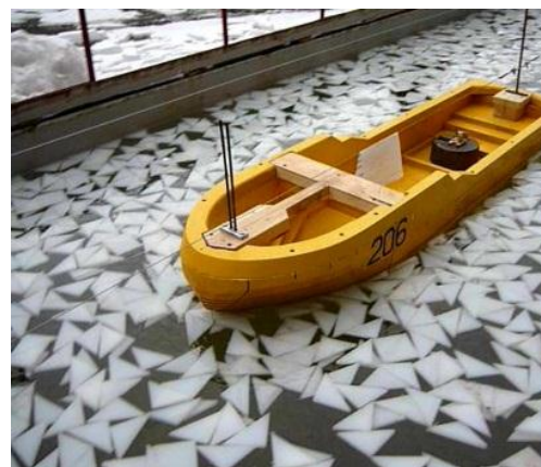
Рис. 5. Фрагмент испытаний модели ледокола в битом льду (в плитках полиэтилена)
