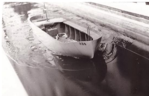
Рис. 4. Фрагмент испытаний ледокола R-класса в естественном льду
