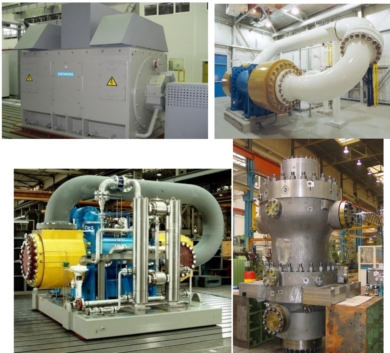
Рис. 1. Варианты новых моноблочных электроприводных газоперекачивающих агрегатов для энергоэффективного транспорта газа
