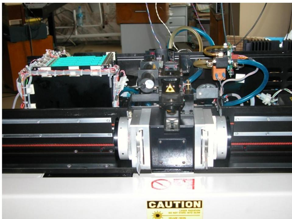
Рис. 3. Измерительная ячейка анализатора заготовок Р-102
