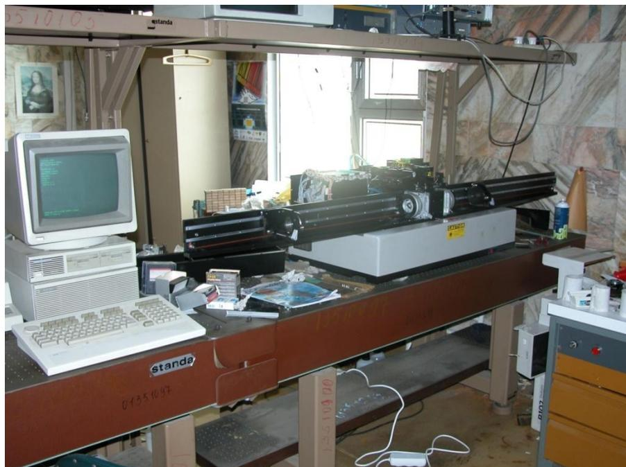
**Рис. 1. Внешний вид анализатора заготовок Р-102 фирмы York Technology для измерения профиля показателя преломления кварцевых заготовок**
