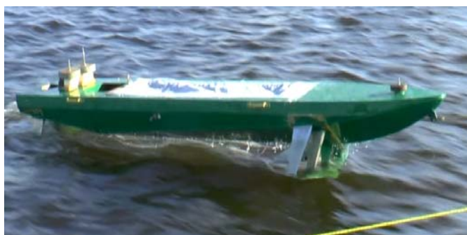
Рис. 4. Движение модели курсом 180° (попутным)
