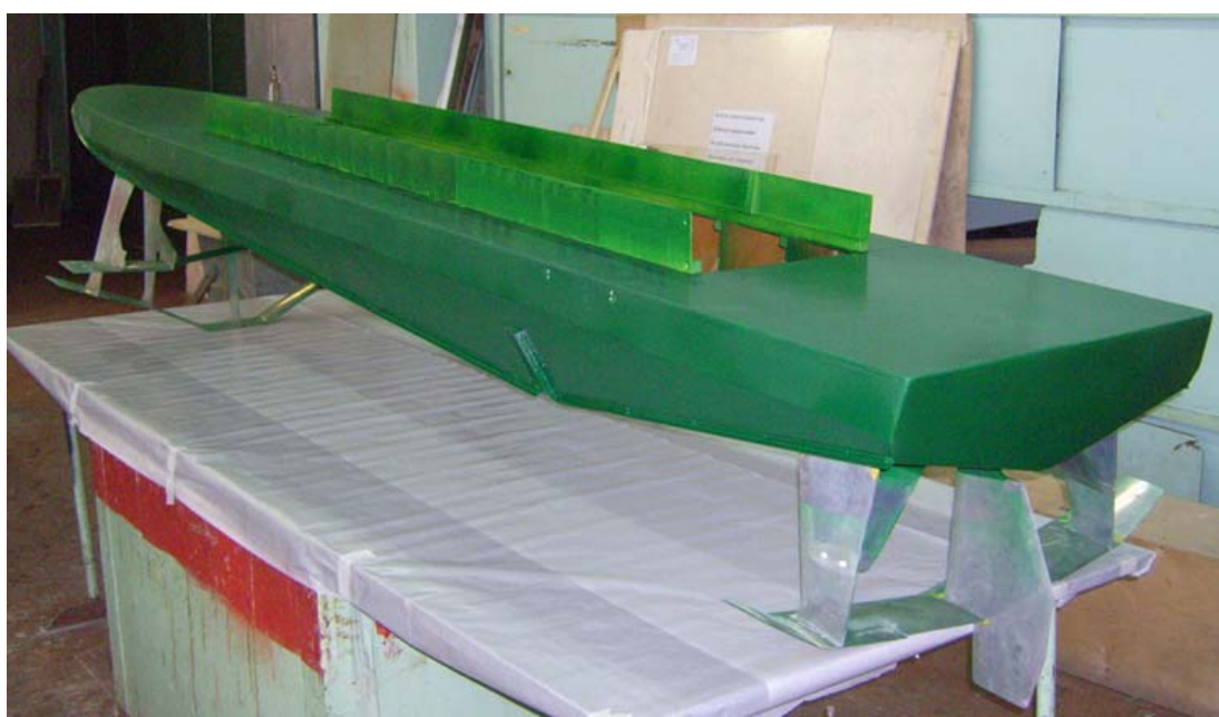
Рис. 1. Общий вид буксируемой модели
