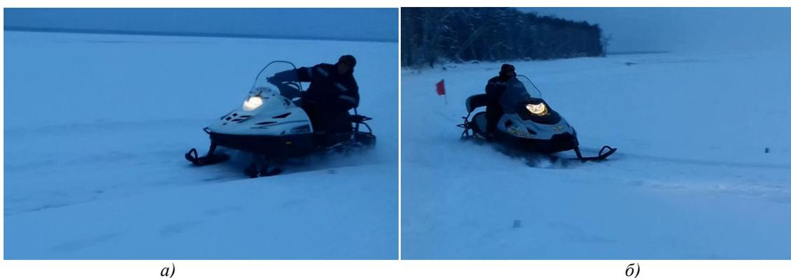
**Рис. 6. Фрагмент проведения испытаний снегоходов при выполнении маневра «Поворот с заданным радиусом  $R_n = 25$  м»:**
