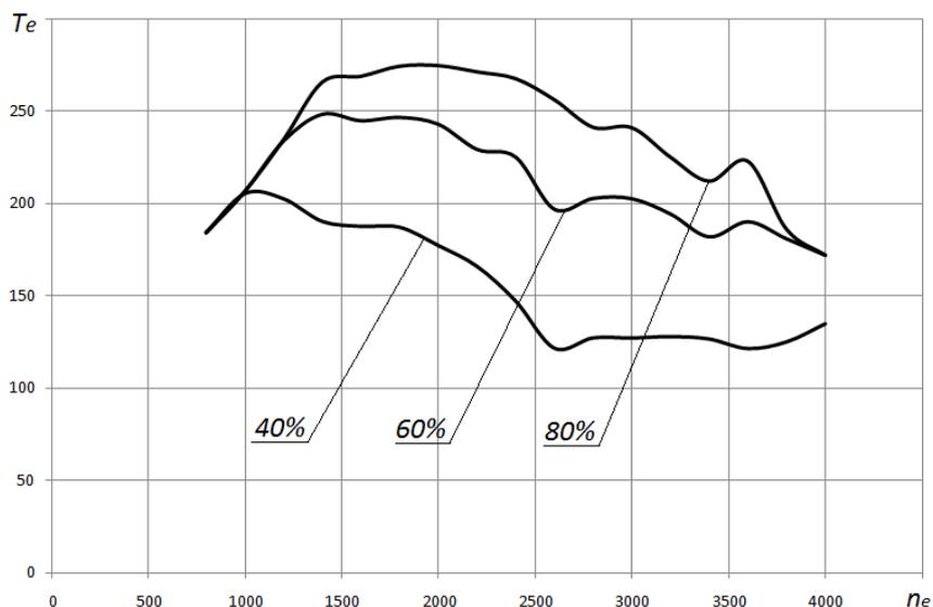
**Рис. 4. Частичные характеристики современного дизельного ДВС при 40, 60 и 80%-ном уровне подачи топлива**
