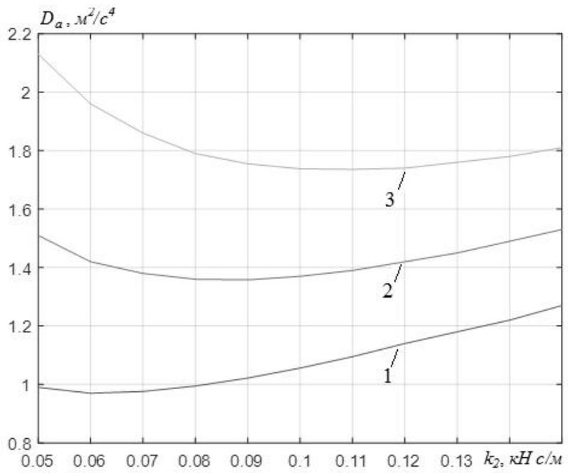
**Рис. 2.** Зависимость дисперсии ускорений  $D_a$  массы  $m_2$  от коэффициента демпфирования  $k_2$  для трёх значений жёсткости упругого элемента
