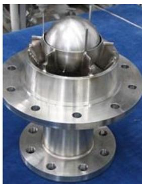
Рис. 1. Упрощенная модель обратного клапана уменьшенного масштаба
