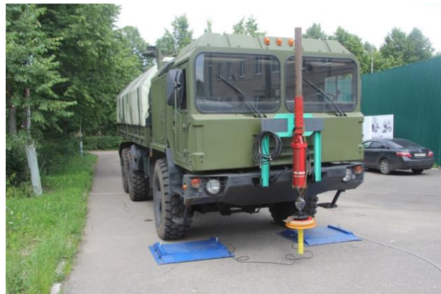
Рис. 2. Используемый тягач МЗКТ-6001 с установленным пенетрометром
