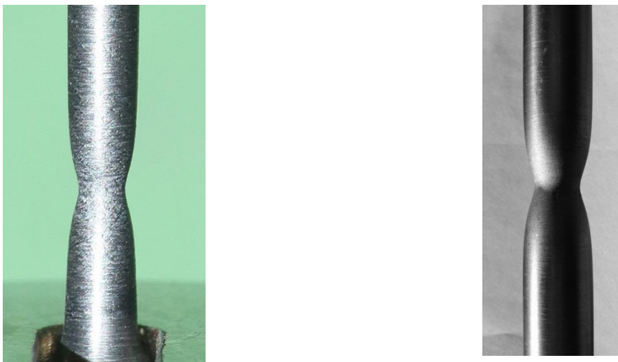
Рис. 7. Фото образцов разного диаметра с развитой шейкой: левое фото D_0=6 мм, правое фото D_0=15 мм
