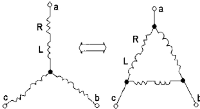
Рис. 9. Соединение обмоток двигателя звездой, треугольником [6]
