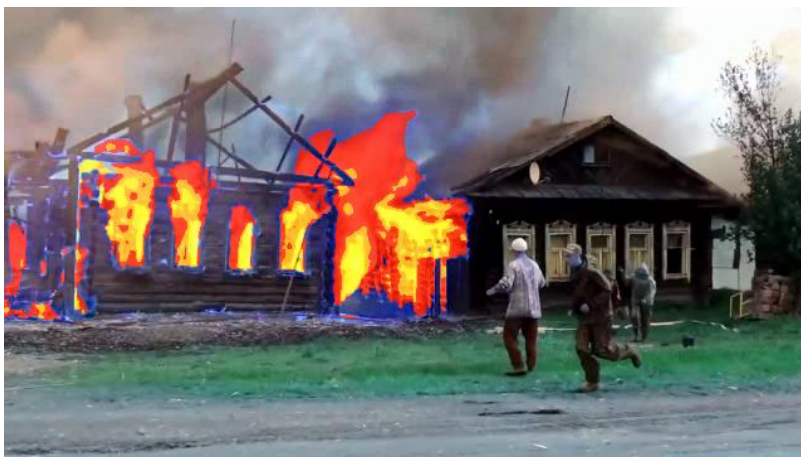
Рис. 7. Результат обнаружения пламени высокотемпературных зон пожара моделью, базирующейся на четырехкадровом анализе
