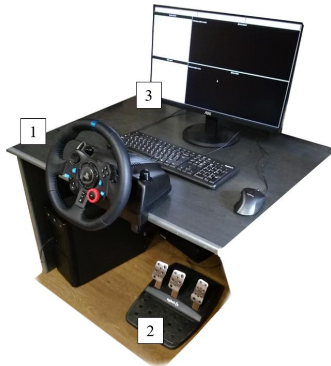
Рис. 3. Внешний вид рабочего места оператора комплекса натурно-математического моделирования: 1,2 – органы управления; 3 – устройство вывода графической информации
