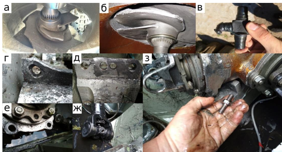
Рис. 1. Разрушения элементов привода водометных движителей:
