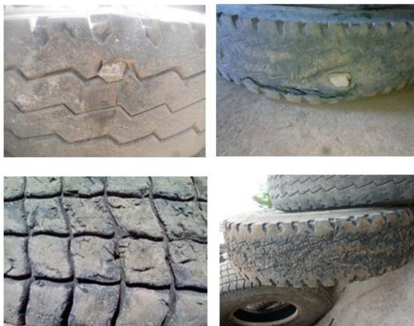
Рис. 3. Механические повреждения автомобильной шины на горной карьерной дороге, засоренных древесными и щебенистыми обломками горных пород
