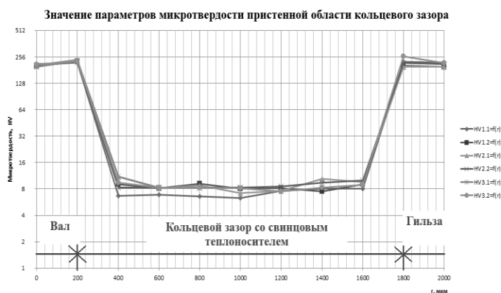
Рис. 7. Микротвердость пристенной области а) при циркуляции в трубопроводе; б) при вращении в кольцевом зазоре
