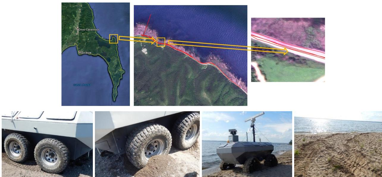
**Рис. 4. Пример траектории движения МАК и характерные фрагменты испытаний**
