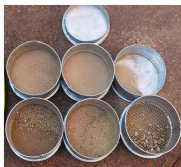
**Рис. 5. Фрагменты определения фракционного состава песка**
