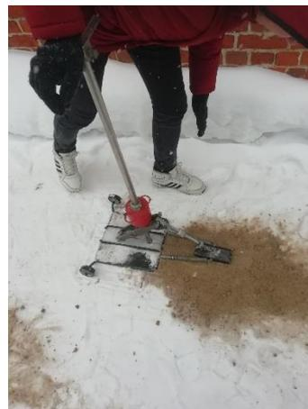
**Рис. 8. Фрагмент испытаний по определению коэффициента сцепления с помощью ИКСп [19]**
