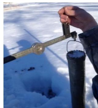
**Рис. 6. Определение плотности снега с помощью ВС-43**
