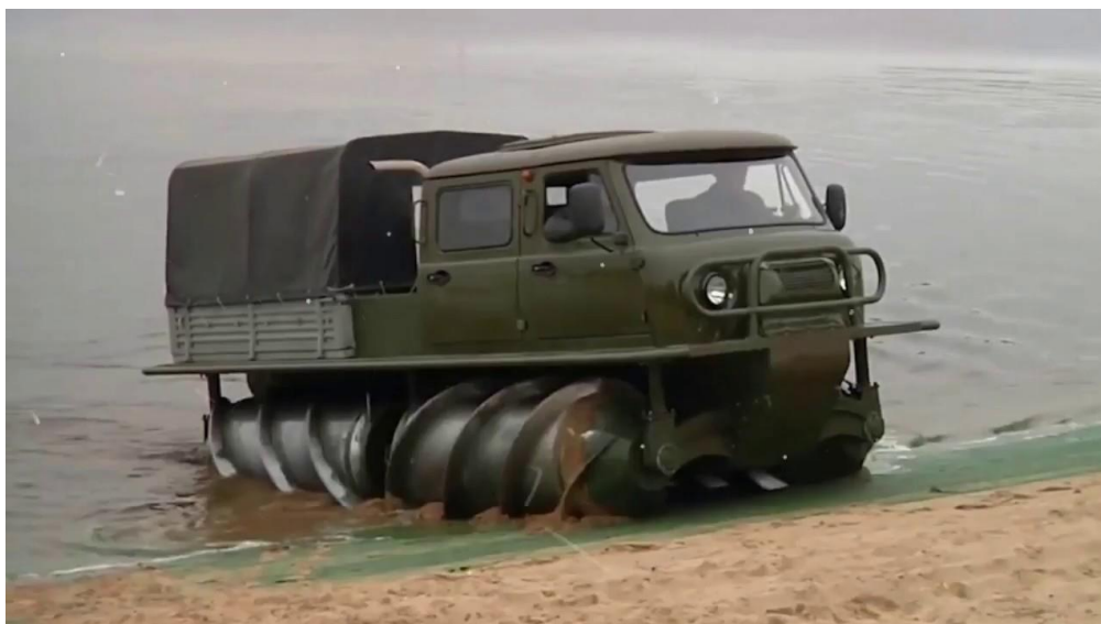
Рис. 1. Снегоболотоход ЗВМ-2401 производства ООО «Завод Вездеходных машин» с четырехсекционной компоновкой роторов
