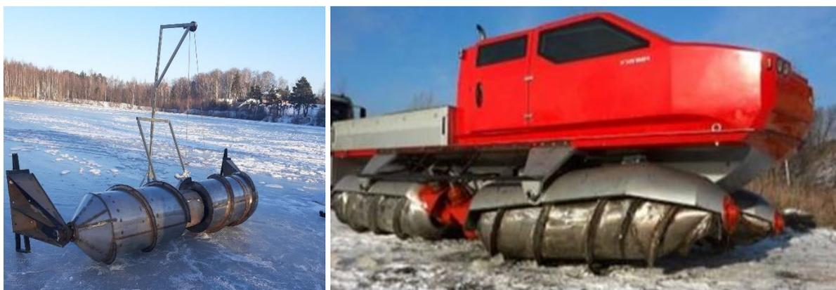
**Рис. 3. Отдельные элементы движителя, на которых проводились исследования**
