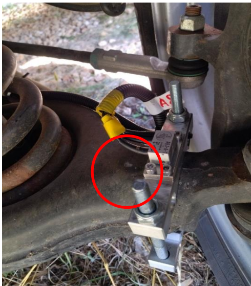
Рис. 4. Способ установки датчика ускорений на неподрессоренной массе автомобиля
