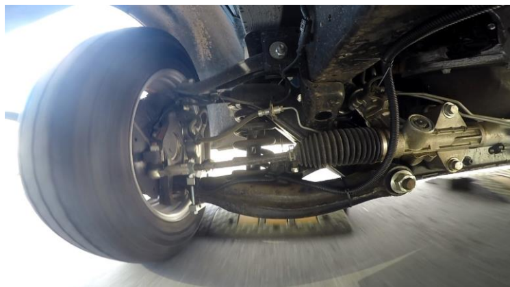
Рис. 6. Работа подвески при преодолении единичной неровности
