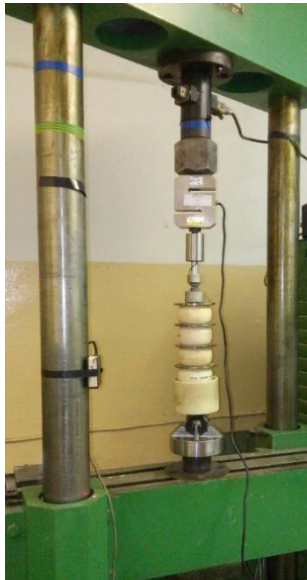
Рис. 8. Стендовая установка для испытаний эластомеров
