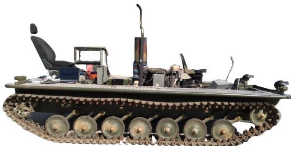
Рис. 3. Макетный образец гусеничной машины, разработанной в МГТУ им. Н.Э. Баумана
