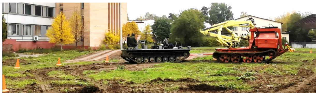
Рис. 13. Гусеничный поезд в процессе выполнения маневра «змейка»
