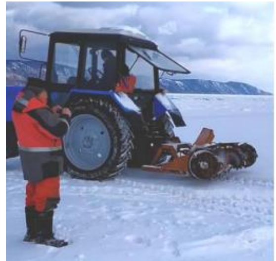
Рис. 1. Работа машины-планировщика с горизонтальной шнековой фрезой
