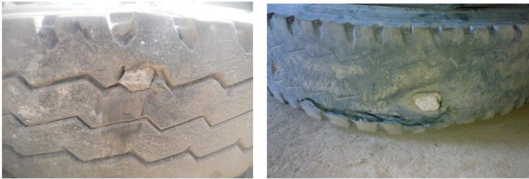
Рис. 4. Глухие проколы шин обломками твердых скальных пород
