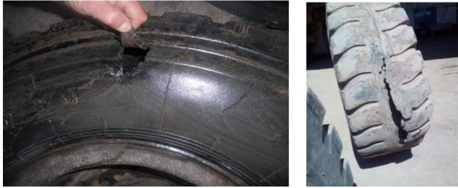
Рис. 2. Механические повреждения шин при эксплуатации в горных условиях
