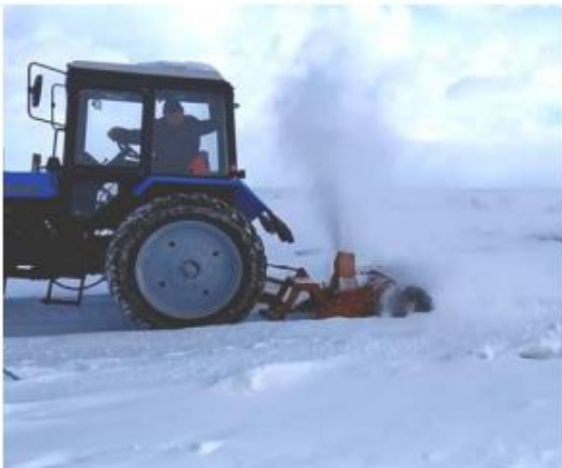
Рис. 1. Работа машины-планировщика с горизонтальной шнековой фрезой
