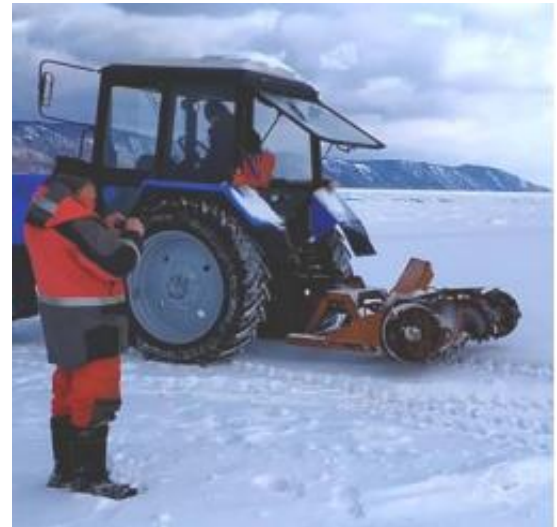
Рис. 1. Работа машины-планировщика с горизонтальной шнековой фрезой
