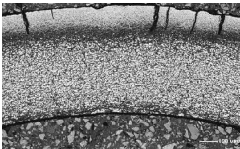
Рис. 4. Поперечный шлиф циркониевого сплава Э110 после наводороживания
