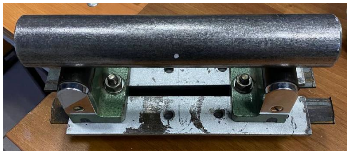
Рис. 15. Исходное состояние испытуемой трубы
