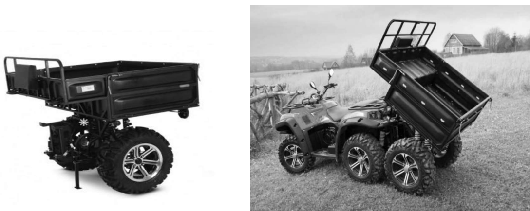
Рис. 1 Демонтируемый модуль грузовой платформы
