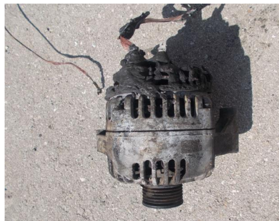
Рис. 4. Пример неисправности, приведшей к полной утрате подвижности техники при возгорании при разгерметизации топливной системы и замыкании диодов генератора
