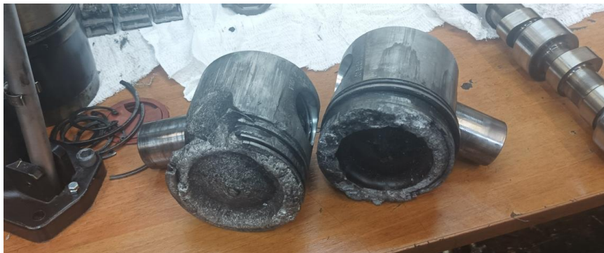
Рис. 3. Пример неисправности, приведшей к полной утрате подвижности техники при неисправных форсунках
