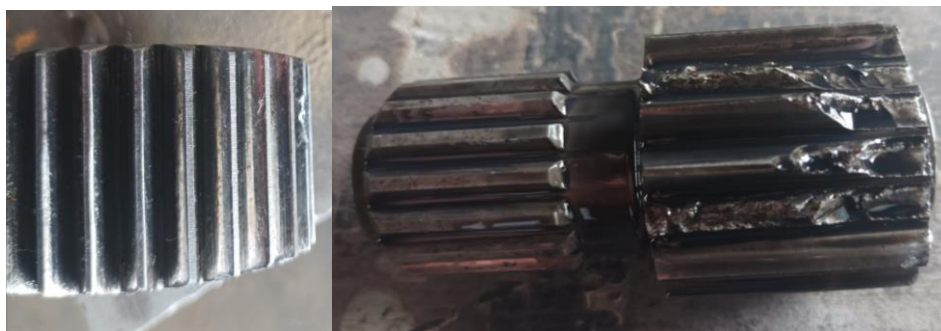
Рис. 10. Начальная и конечная стадии выкрашивания зубьев шестерен
