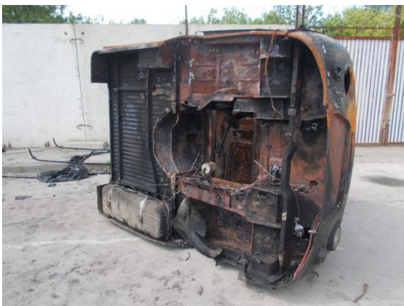
Рис. 4. Пример неисправности, приведшей к полной утрате подвижности техники при возгорании при разгерметизации топливной системы и замыкании диодов генератора
