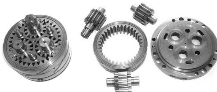
**Рис. 3. Опытный образец гидромеханического дифференциального механизма (гидронасос с шестернями внутреннего зацепления)**
