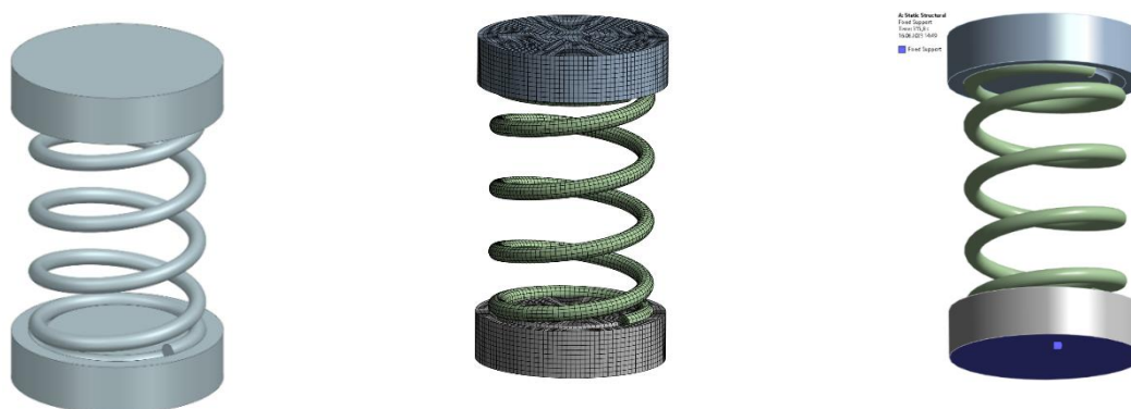
Рис. 8. Расчетная модель пружины с нешлифованными витками
