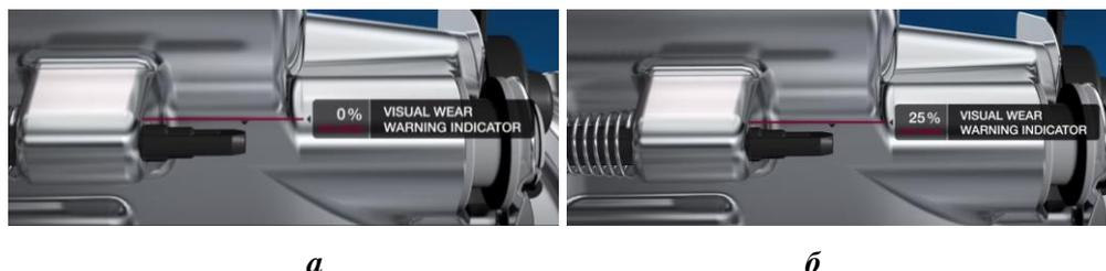
**Рис. 8. Контроль износа колодок:**
