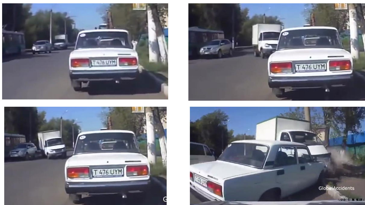
Рис. 1. Типичная траектория движения перед ДТП автомобиля, водитель которого не справился с управлением (при наличии времени реакции на начало выполнения маневра) Fig. 1. A typical trajectory before an accident of a vehicle whose driver has lost control (given the time to react to the start of the maneuver)
