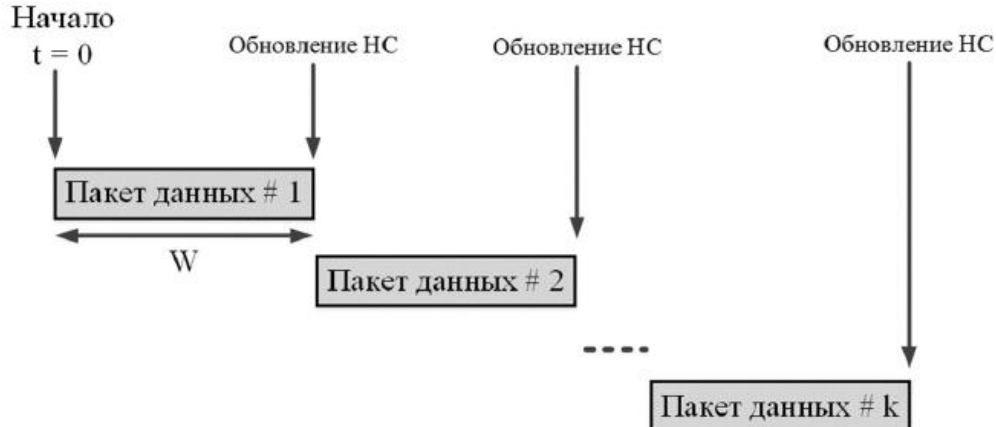
Рис. 2. Схема обновления НС неперекрывающимся перемещаемым окном
