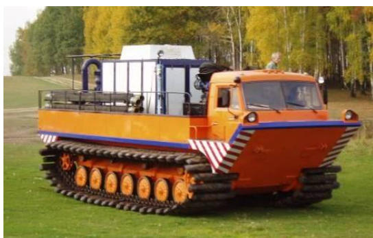
Рис. 28. ТТМ-6901ПНУ – снегоболотоход с насосной установкой
