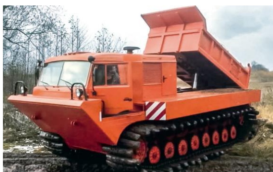
Рис. 30. ТТМ-6901ГС – снегоболотоход с самосвальной установкой
