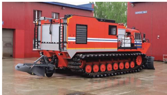
Рис. 32. ТТМ-6901ПЖ – снегоболотоход с комплектом пожарного оборудования для тушения лесных пожаров
