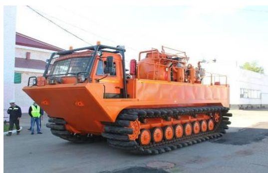
Рис. 31. ТТМ-6902АКМ с вакуумной нефтепромысловой цистерной АКН-7,5 ОД
