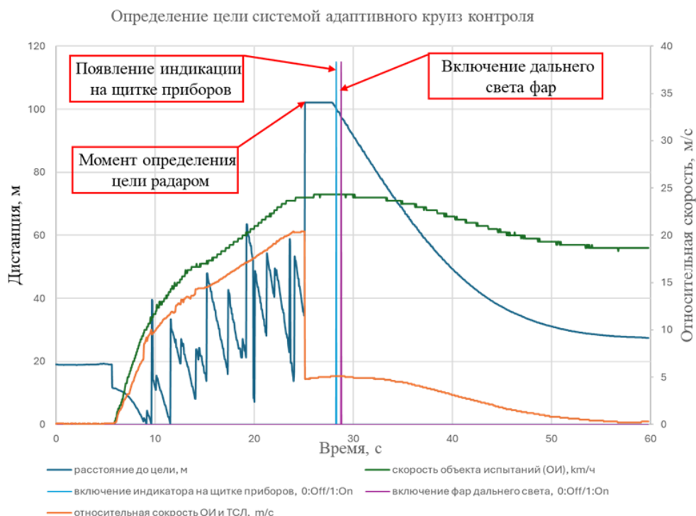
Рис. 7. Изменение дистанции между ОИ и ТСЛ, относительной скорости и скорости ОИ в случае чистого радара
