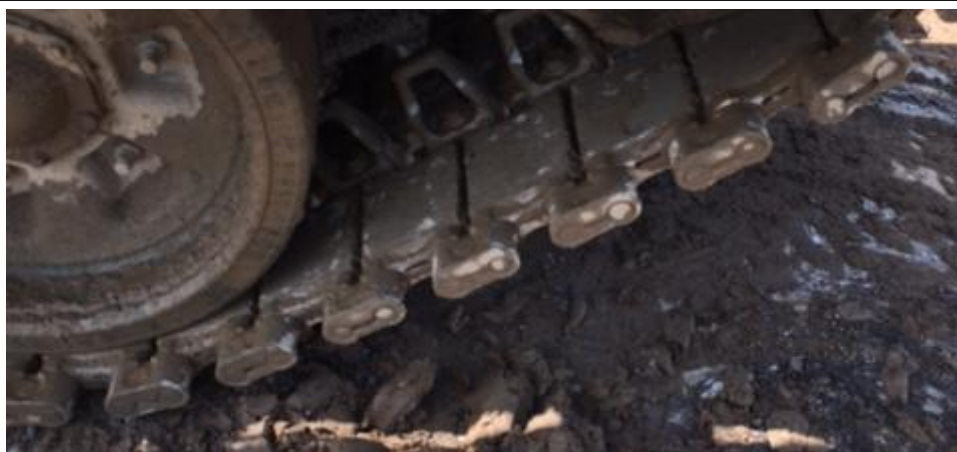
Рис. 2. Гусеница и опорный каток испытываемого объекта
