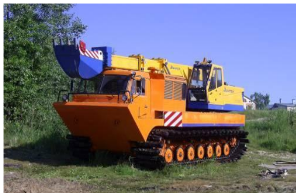
Рис 27. ТТМ-6901Э – снегоболотоход с экскаваторной установкой
