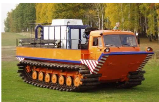
Рис. 28. ТТМ-6901ПНУ – снегоболотоход с насосной установкой
