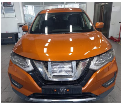
Рис. 6. Установка экранирующей решетки на Nissan X-Trail
