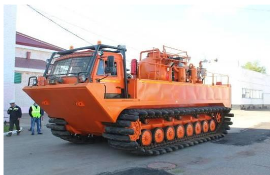
Рис. 31. ТТМ-6902АКМ с вакуумной нефтепромысловой цистерной АКН-7,5 ОД
