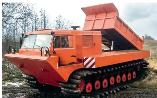
Рис. 30. ТТМ-6901ГС – снегоболотоход с самосвальной установкой
