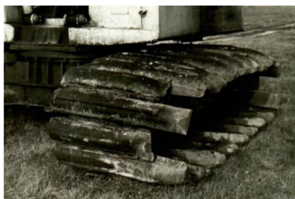
Рис. 20. Пневмогусеничный движитель экскаватора
