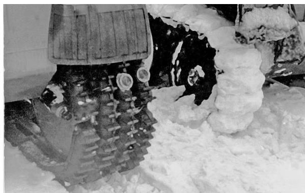
Рис. 16. Состояние пневматической и металлической гусениц при движении по снегу при температуре воздуха, близкой к нулевой
