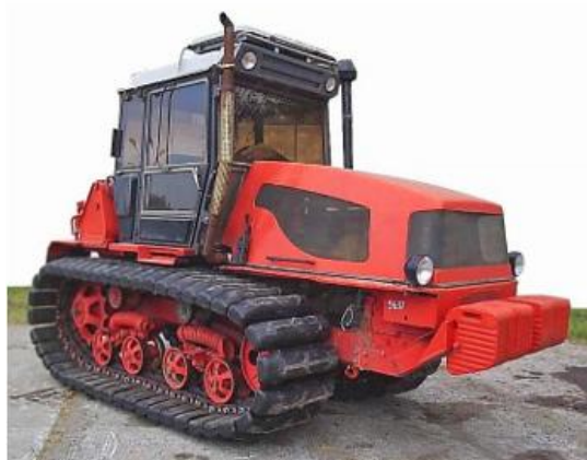
Рис. 23. Трактор ВТ-150 на пневматических гусеницах
