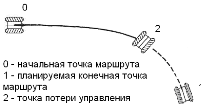
Рис. 3. Схематичное изображение потери управления роторно-винтовой машины при выполнении поворота
