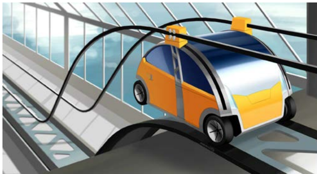
Рис. 1. Двухрежимное скоростное персональное транспортное средство (PRT-ZEST)
