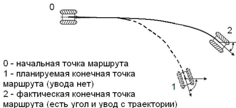
Рис. 4. Схематичное представление поворота роторно-винтовой машины в общем виде
