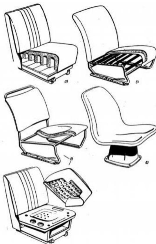
**Рис. 4. Сиденья с неметаллическими упругими элементами:**
