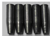
**Рис. 2. Примеры сердечников пуль ПС 43 ТУС с отличиями в геометрии**
