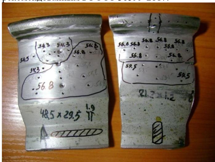
Рис.1. Твердость образцов в зоне сварочного шва и в соседних областях
