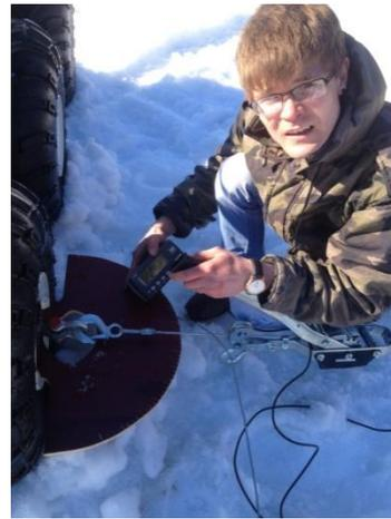
**Рис. 2. Замер силы сопротивления повороту на ТС «Корсак» на снегу**
