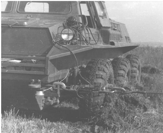
**Рис. 1. Замер силы сопротивления повороту на ГПИ-3901 на грунте**
