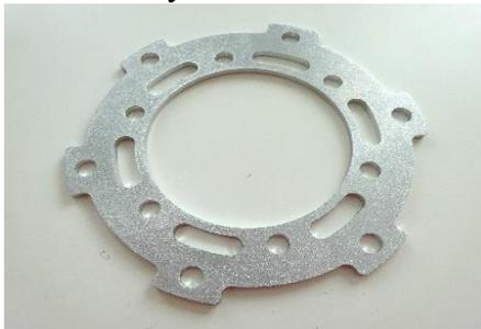
**Рис. 1. Крепления ведомой звезды на корпусе межосевого дифференциала**
