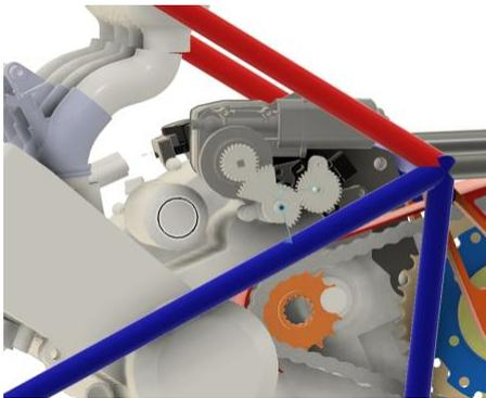
**Рис. 2. Мехатронная система переключения скоростей**
