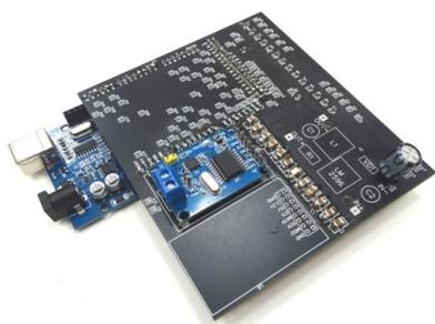
Рис. 2. ЭБУ трансмиссии спортивного автомобиля класса FORMULA STUDENT
