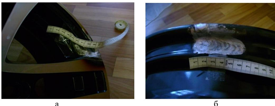
**Рис. 1. Фрагмент колеса со сварочным швом в зоне сопряжения спицы колеса с ободом:**
