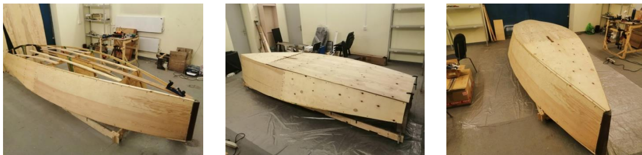
Рис. 2. Процесс постройки швертбота «Ворьен»
