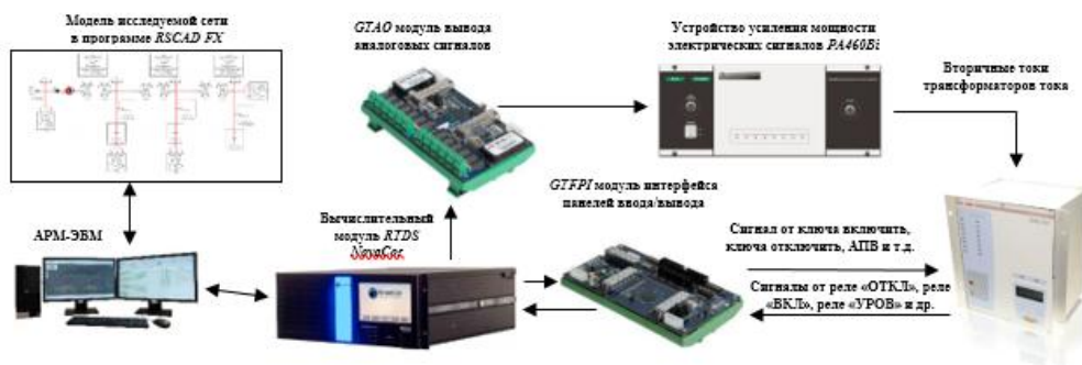
Рис. 1. Структура функциональных испытаний и модель сети для испытания РЗА
