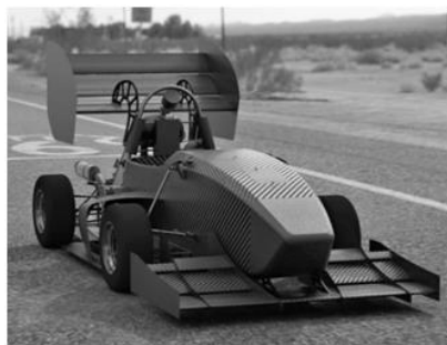
Рис. 2. Несущие системы из композитных материалов
