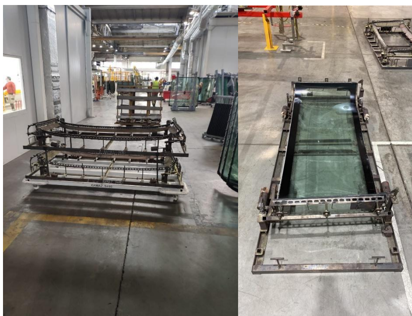
Рис.2. Формы молирования стекла
