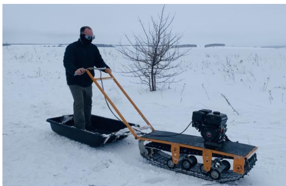
Рис.1. Мотобуксировщик разработки НГТУ им. Р.Е. Алексеева с колесным (а) и санным (б) прицепными устройствами
