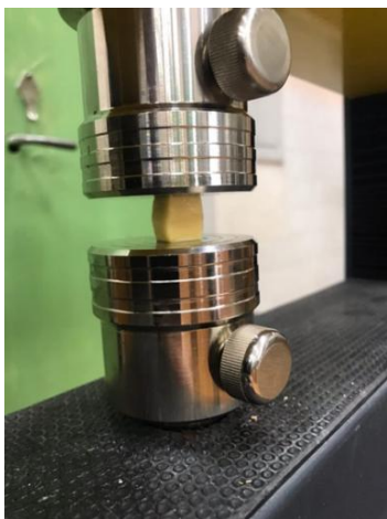
Рис. 1. Образец, установленный в испытательную установку МИ50У
