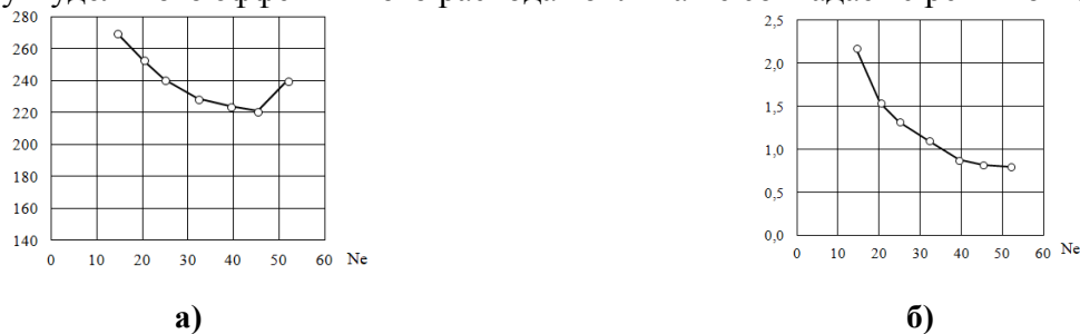
Рис. 1. Результаты обработки экспериментальных данных: а) удельный эффективный расход; б) коэффициент избытка воздуха топлива
