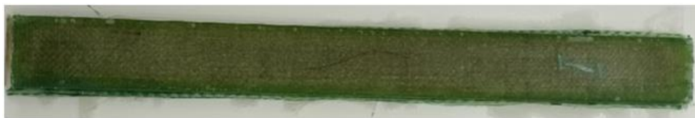
Рис.1. Прототип толкателя амортизатора подвески, выполненный из ПКМ
