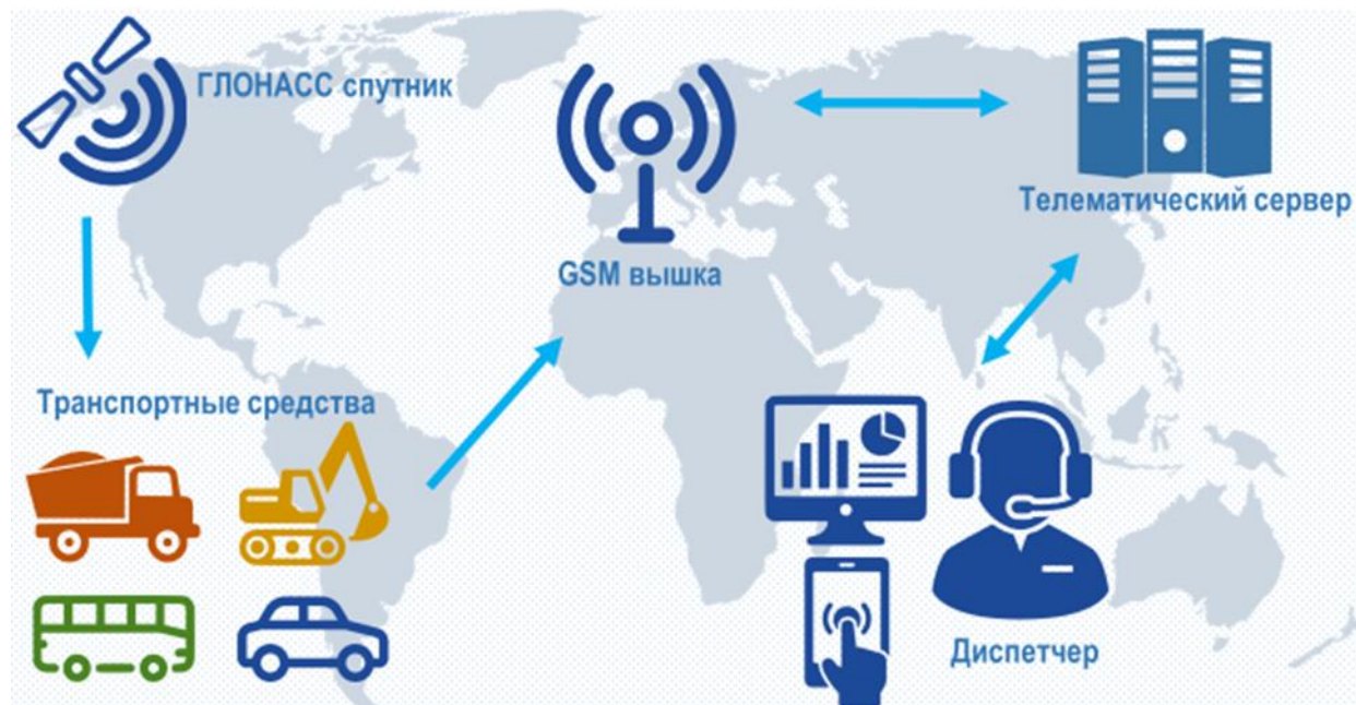
Рис.1. Принцип работы системы ГЛОНАСС на автотранспортном предприятии
