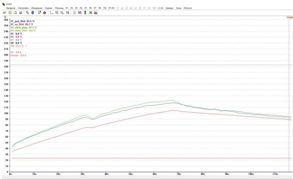
Рис. 2. Фотография экрана монитора с изображением термопрофиля пайки платы адаптерного блока во время циклов обработки, снятого в режиме реального времени
