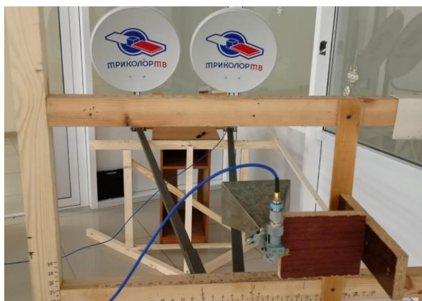
Рис. 4. Позиционирование параболических антенн с помощью рупорной антенны
