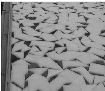
**Рис. 5. Модельный лед в виде треугольных плиток полиэтилена**
