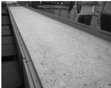
**Рис. 6. Модельный лед в виде гранул полиэтилена**
