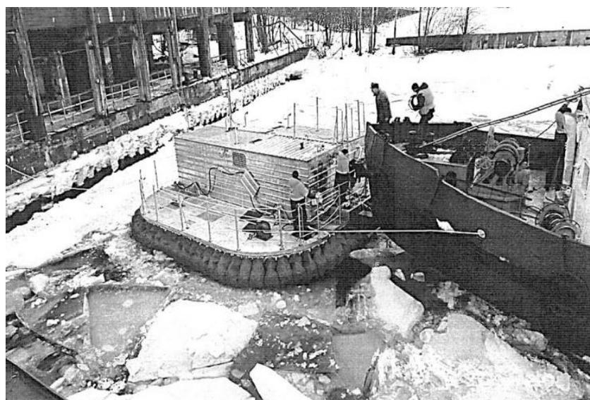
**Рис. 4. Счаливание ЛПВП с буксиром [2]**
