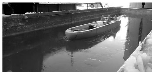
**Рис. 10. Испытания модели ледокола в сплошном льду**
