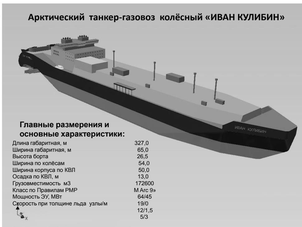
Рис. 5. Танкер СПГ, оборудованный ЛКДРК – ледофрез «Иван Кулибин»
