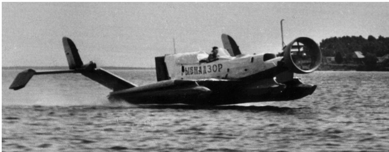
Рис. 2. Экспериментальный исследовательский экраноплан СМ-9
