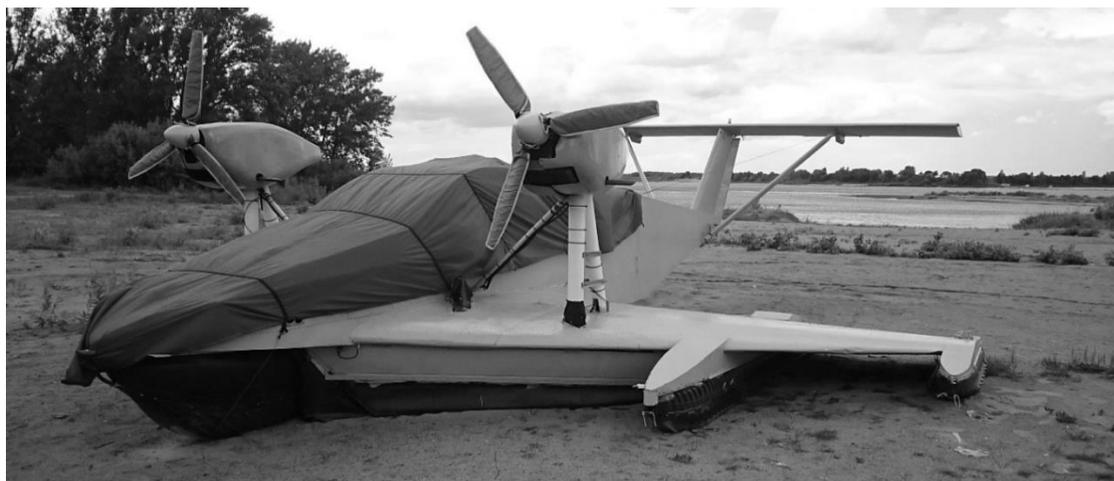
Рис. 3. Амфибийный экраноплан «Тунгус»
