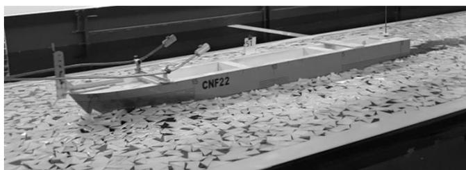
**Рис. 9. Испытания модели судна в битом льду**
