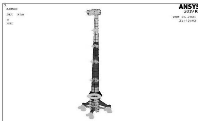
**Рис. 4. Приложение пробной внешней нагрузки на ВЭУ по уровням в ANSYS**
