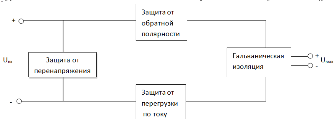
Рис. 1 Структурная схема входного каскада
