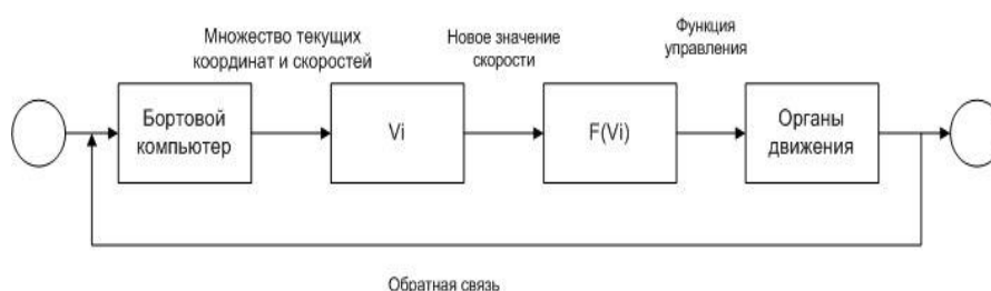
Рис. 3. Схема управления БПЛА
