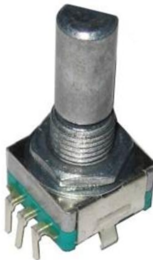
Рис. 6. Простой инкрементальный энкодер
