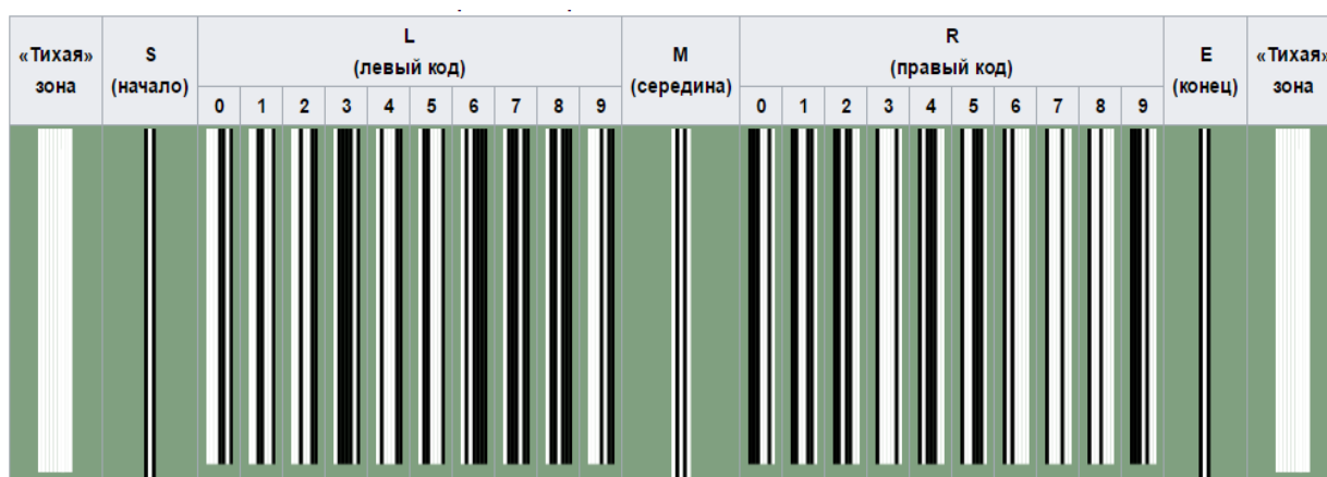
Рис. 1. Кодирование цифр в стандарте UPC-A
