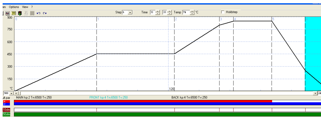
Рис. 2. Программа обжига заготовок МКП из керамики SK-47 («КЕКО 850» длительность 240 мин.)
