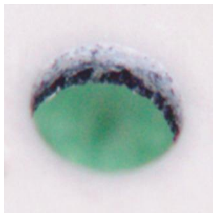
Рис. 1. Фотография отверстия после лазерной обработки подложки из керамики В20 толщиной 0,5 мм
