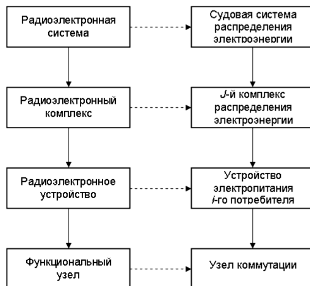
Рис. 3. Уровни разукрупнения (структуризации) по функциональной сложности
