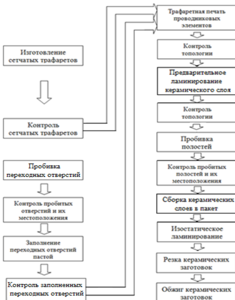
Рис. 1. Маршрут изготовления многослойных керамических плат по технологии LTCC с использованием отечественной системы материалов
