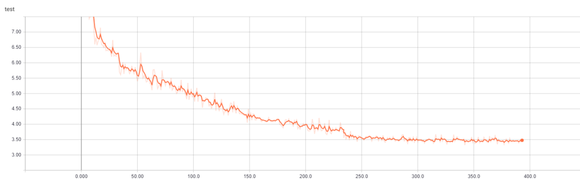
Рис.13. График изменения функции потерь (на тестовой выборке) U-Net + LeakyReLU
