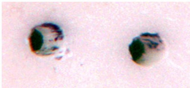
Рис. 3. Фотография отверстий в подложке после обжига при температуре 300 °С
