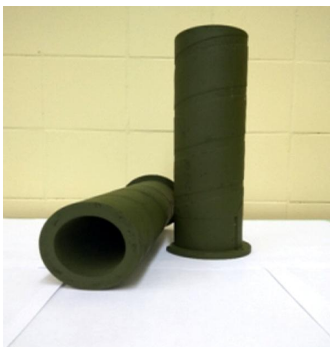
Рис. 2. Макет корпуса антенного излучателя из пенополистирола
