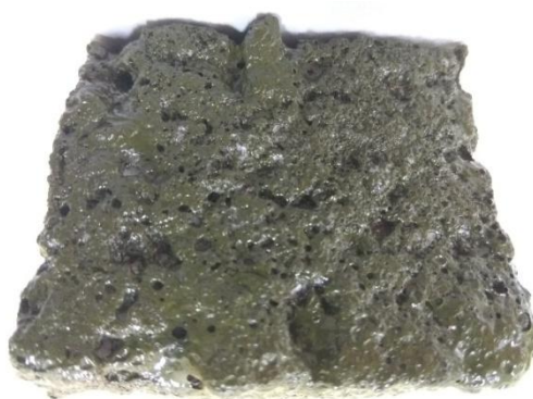
Рис.1. Разрушение окрашенной поверхности пенополистирола под воздействием растворителей содержащихся в органоразбавляемых эмалях
