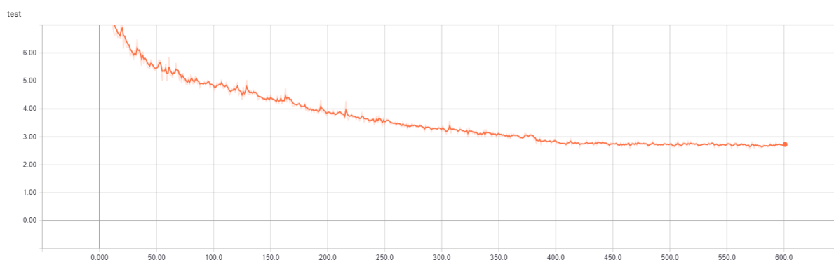
Рис.15. График изменения функции потерь (на тестовой выборке) U-Net + PReLU
