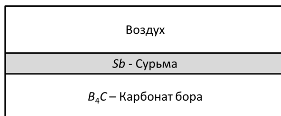
Рисунок 2. Многослойная плоскопараллельная структура, состоящая из пары веществ сурьма/карбонат бора
