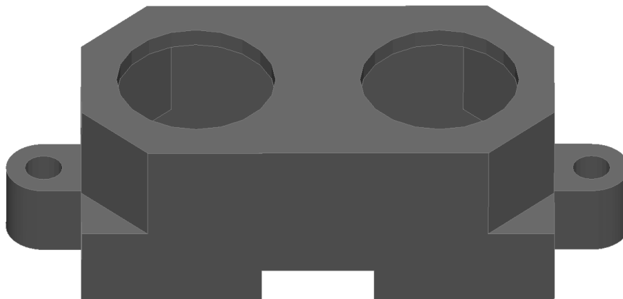
Рисунок 5. Корпус датчика HC-SR04
