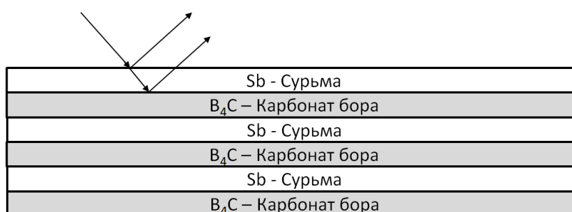
Рисунок 1. Схема многослойного покрытия, состоящая из пары веществ сурьма/карбонат бора
