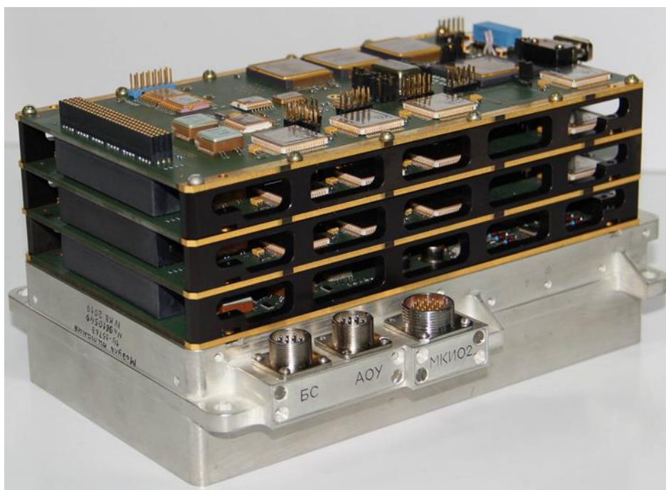
Рис. 1. Трехканальный вычислитель с «холодным» резервированием
