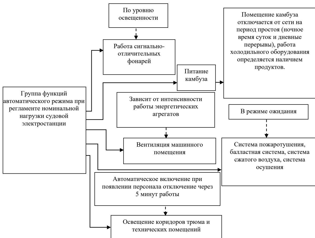
Рис. 2. CASE-диаграмма для объектов автоматического управления при регламенте номинальной нагрузки судовой электростанции
