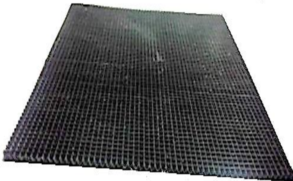
Рис. 3. Лист РПМ, отпрессованный в пресс-форме с вкладышем
