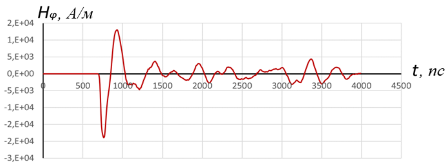
Рис. 5. Временная зависимость компоненты поля H_\phi на поверхности облучателя
