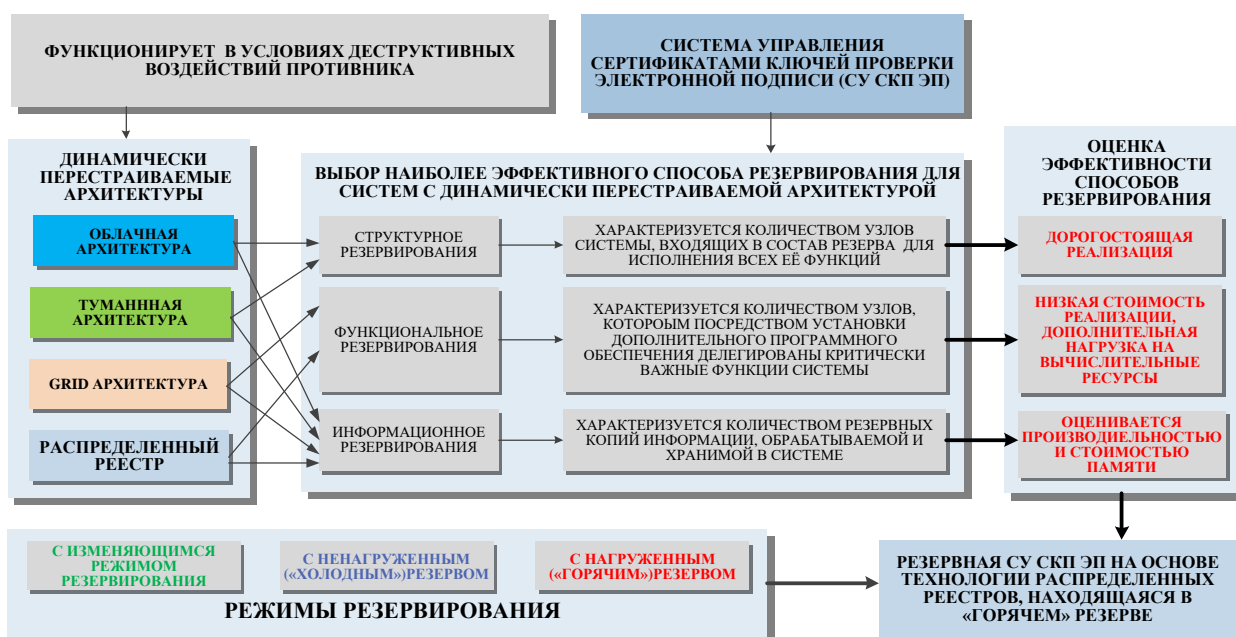
Рис. 3. Анализ технологий с динамически перестраиваемой архитектурой для реализации резервной СУ СКП ЭП
