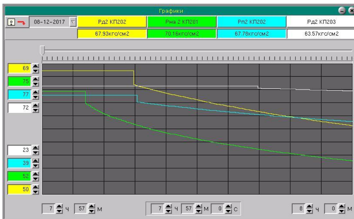
Рис. 7. Графики датчиков давлений после разрыва газопровода
