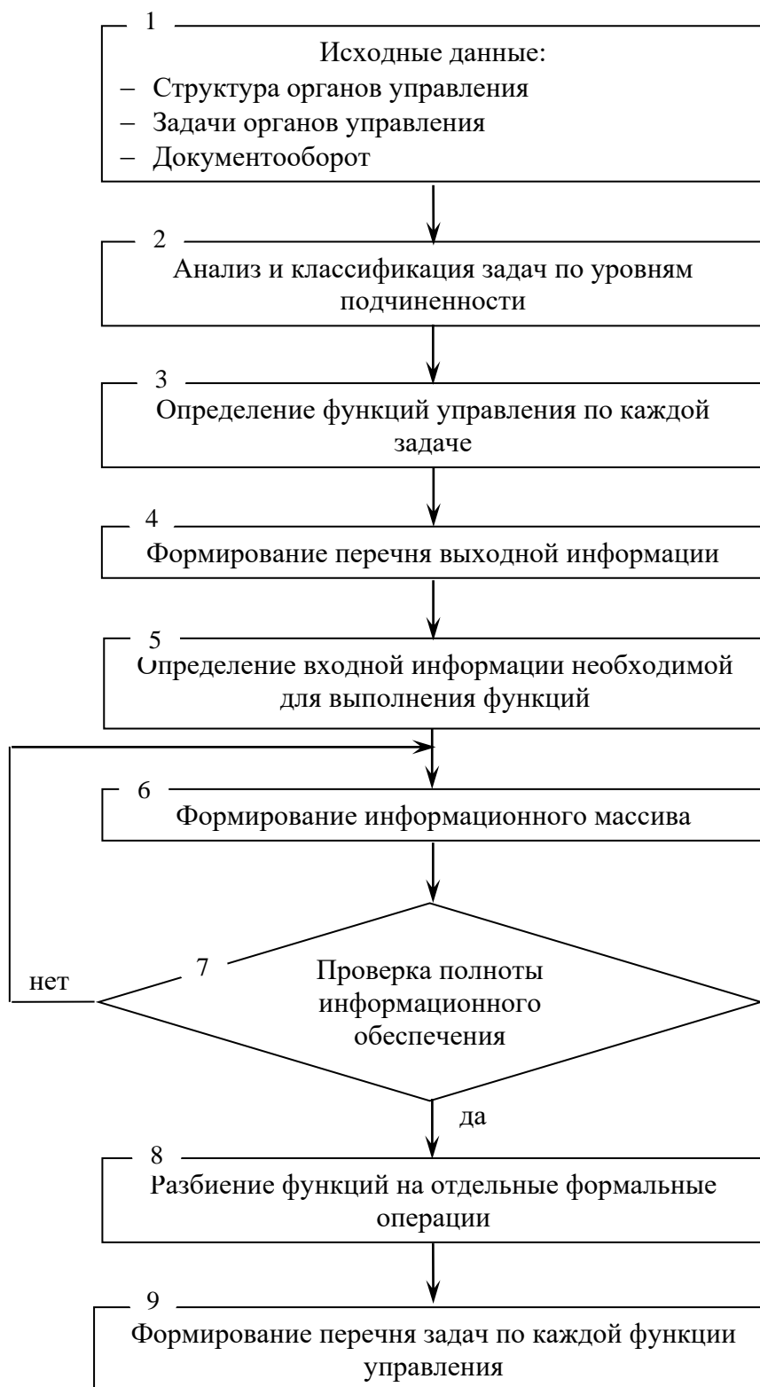
Рис.1. Алгоритм определения перечня задач управления, подлежащих автоматизации
