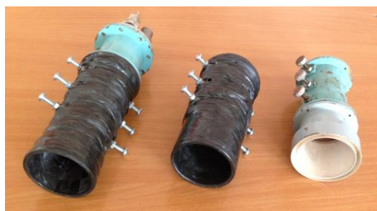
Рис. 2. Рупорные антенны С- диапазона с возбуждающим устройством и поляризатором из УКМ (слева и в центре) и из металла (справа).
