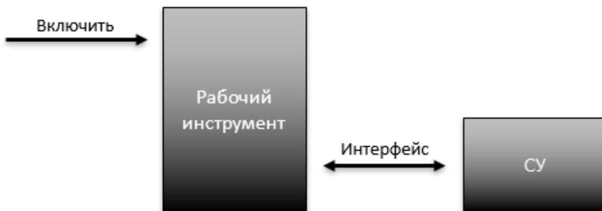
Рис. 3. Типовая схема взаимодействия системы управления с рабочим инструментом
