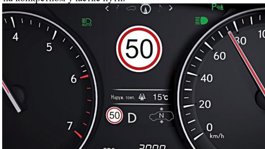
Рис. 3. Информация на дисплее после распознавания знака (ограничение скорости 50 км/ч) [3]
