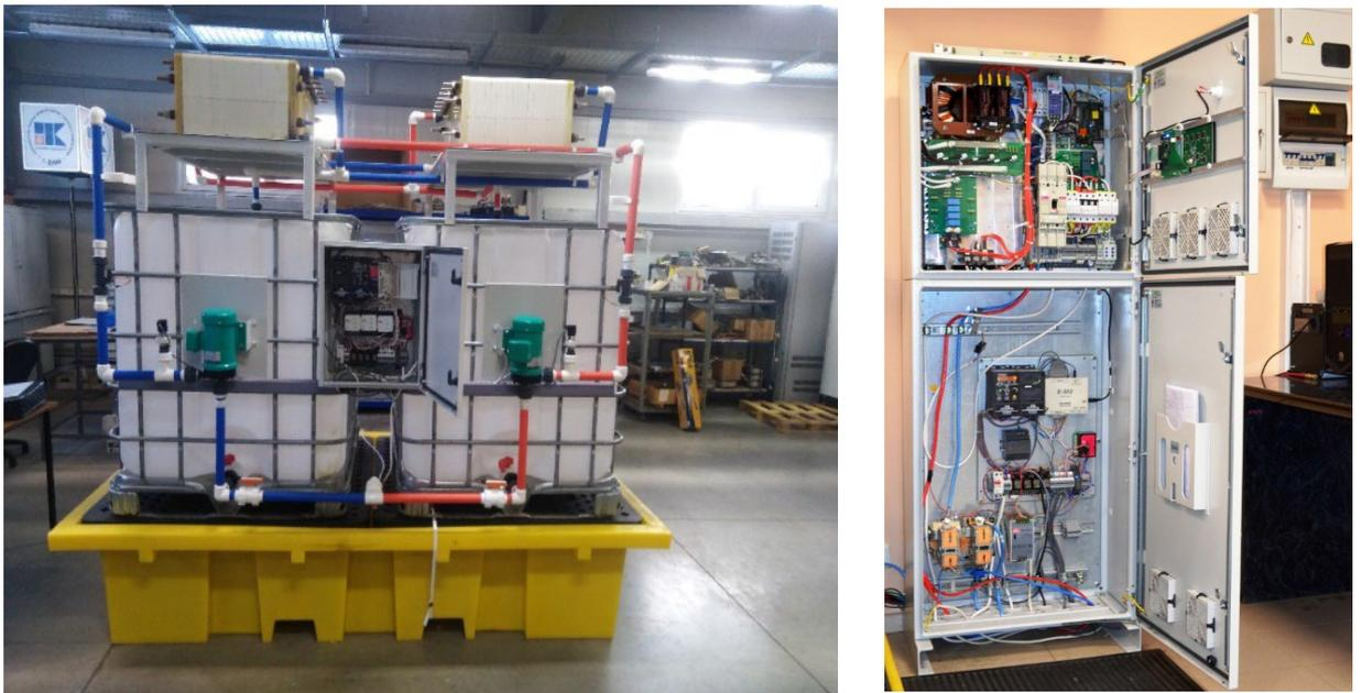
Рисунок 13 – Стенд проточного аккумулятора, зарядное устройство и система управления стендом
