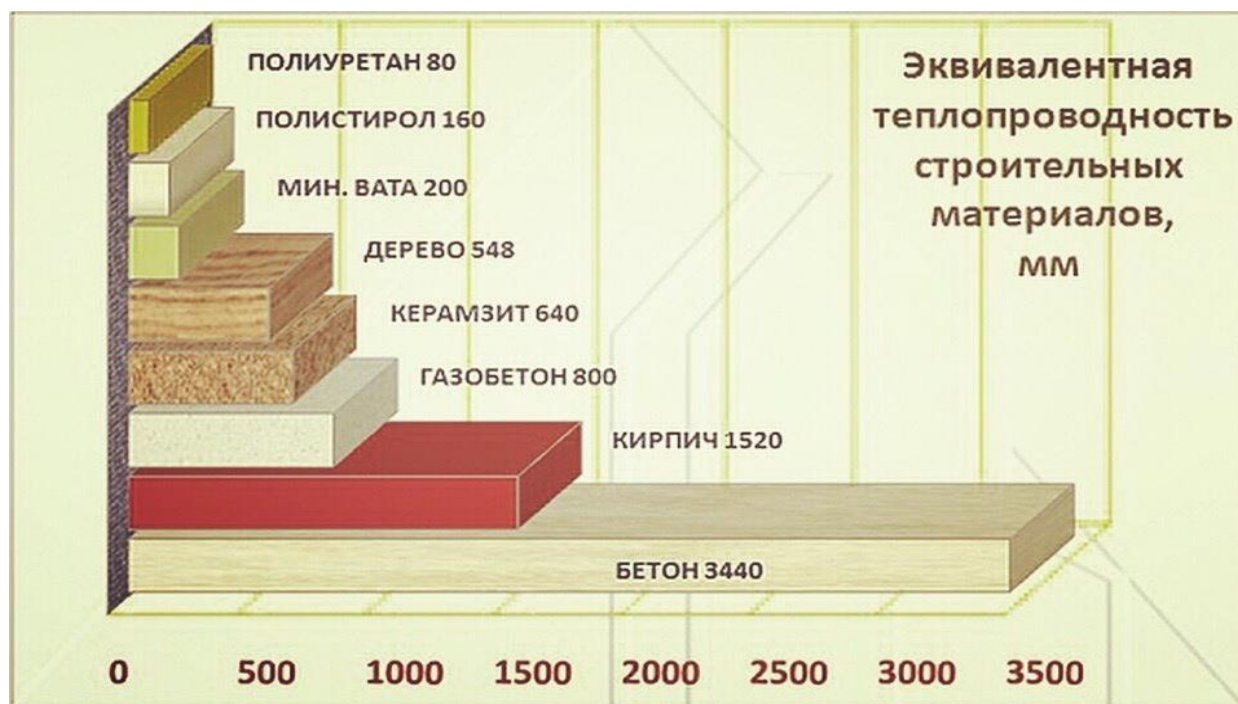
Рис. 4. Эквивалентные величины теплопроводности строительных материалов
