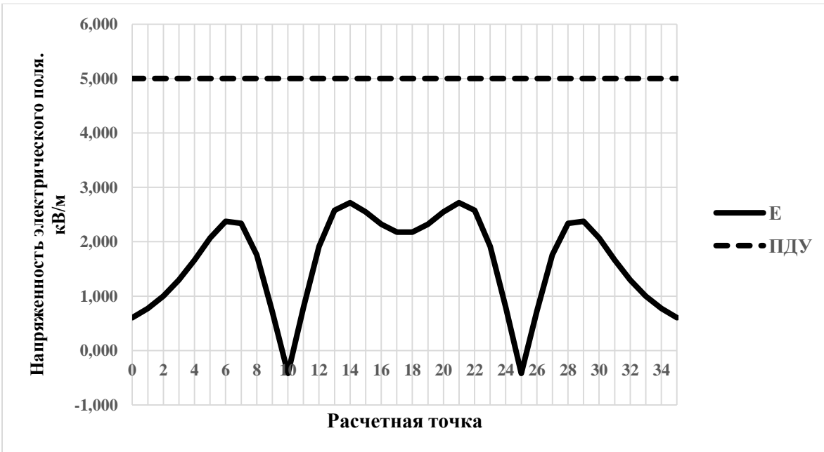
Рис. 3. Результаты расчета напряженности электрического поля для минимальной высоты подвеса
