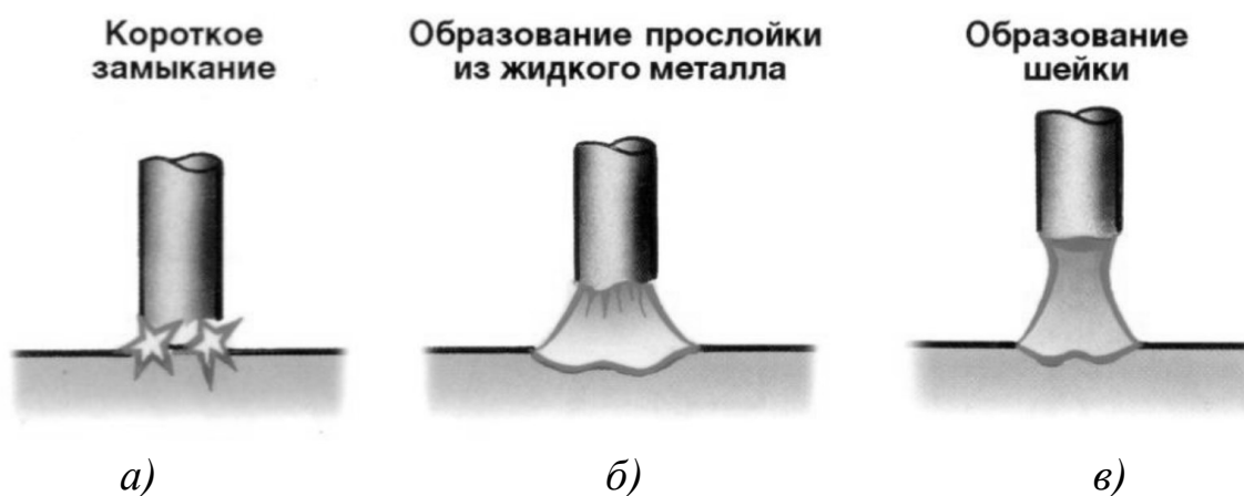
Рис. 1.3. Возбуждение сварочной дуги
