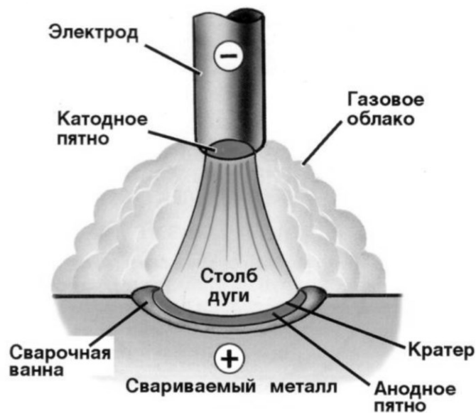
Рис. 1.4. Схема горения сварочной дуги
