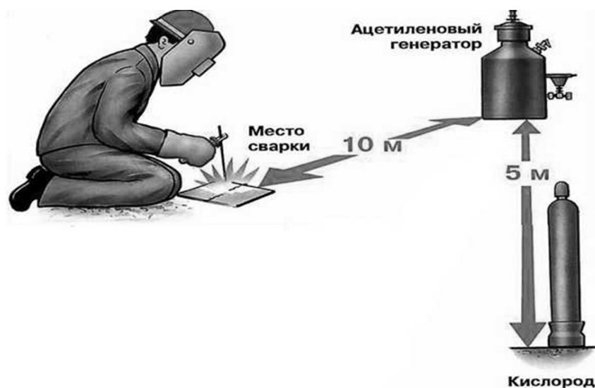
Рис. 4.11. Расстояние от места сварки к баллонам
