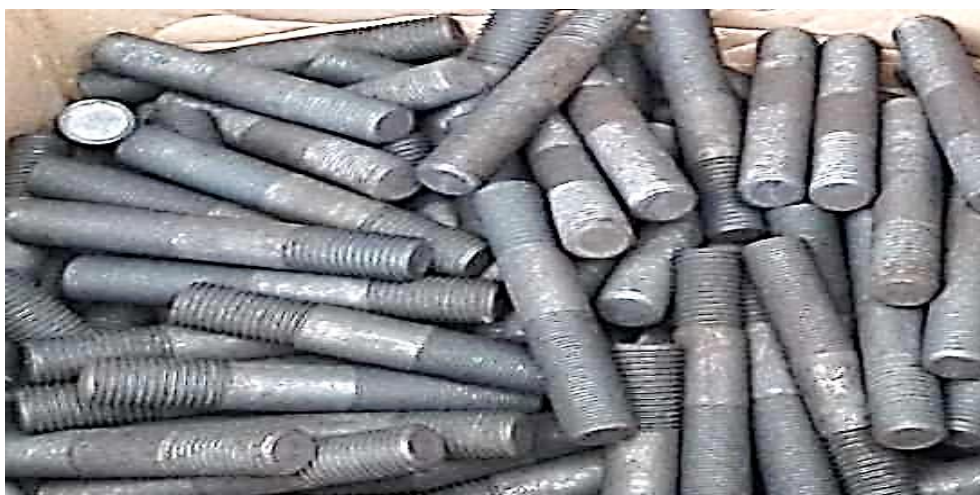
Рис. 1.8. Шпильки, полученные из калиброванного проката
