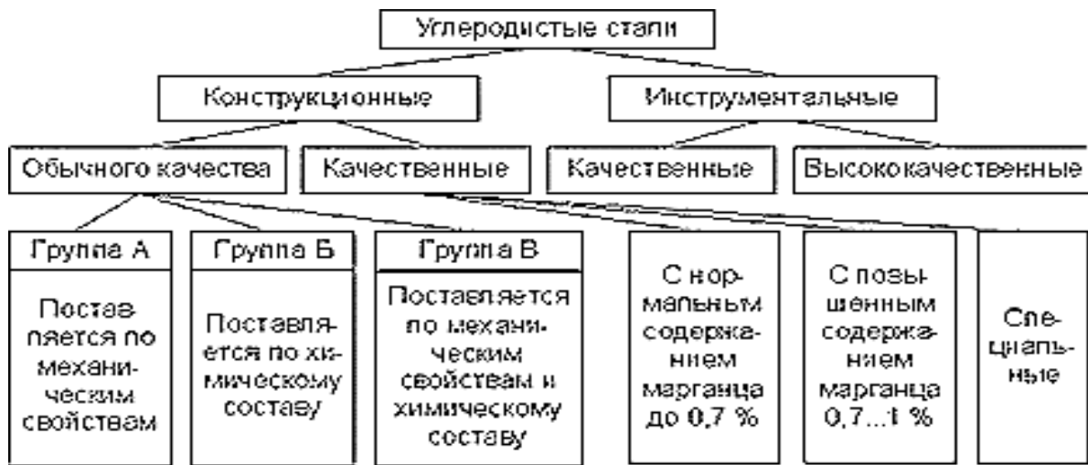
Рис. 2.2. Классификация углеродистых сталей
