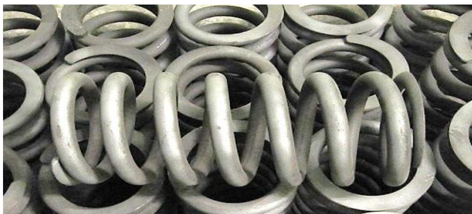
Рис. 5.28. Поверхность пружин после обработки дробью
