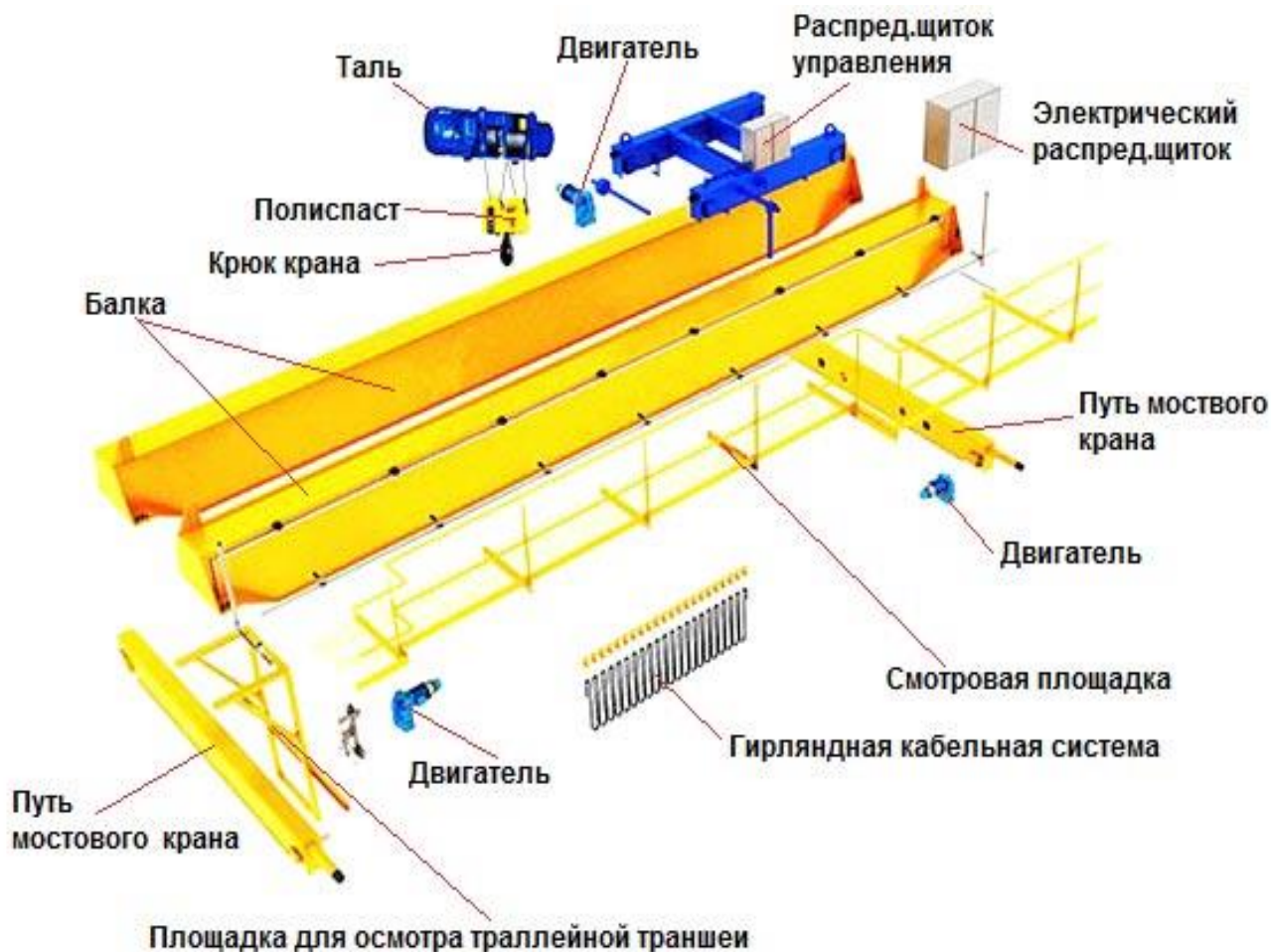
Рис. 7.8. Общее устройство мостового крана
