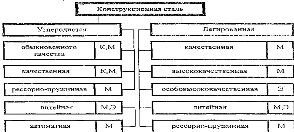
Рис. 2.3. Классификация конструкционных сталей показана
