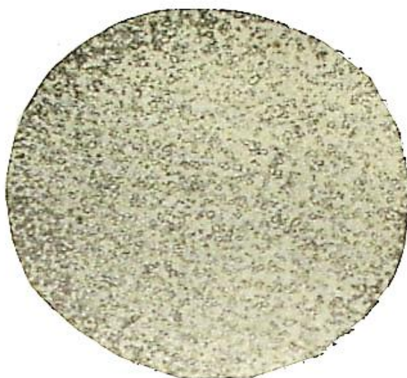
Рис. 1.3. Микроструктура зернистого перлита
