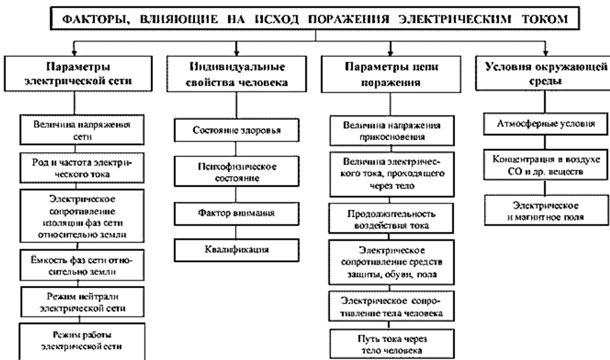
Рис. 7.1. Факторы влияния на исход поражения электрическим током
