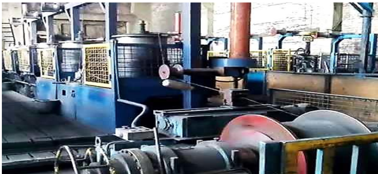
Рис. 1.6. Волочение проката на волочильном стане
