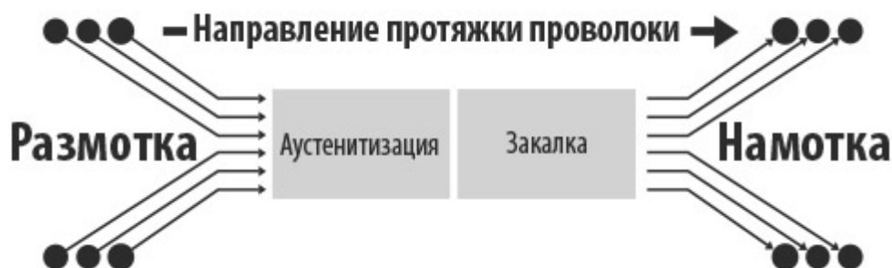
Рис. 8.10. Схема патентирования проката
