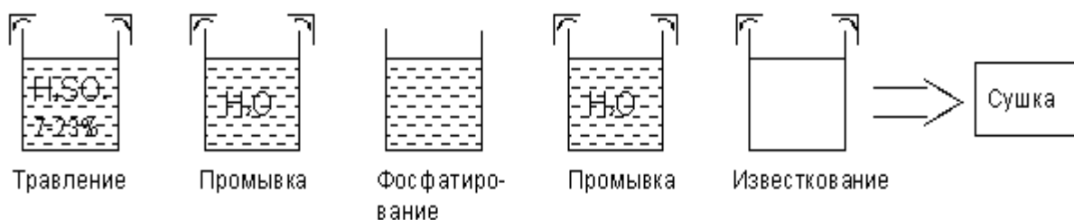
Рис. 5.3. Операции подготовки поверхности проката для волочения
